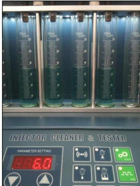
Figura 3-17 Simulación de suministro de combustible (gasolina extra) a 5500 rpm con un pulso de inyección de 6 ms (milisegundos) y un tiempo de duración de la prueba de 60 segundos
