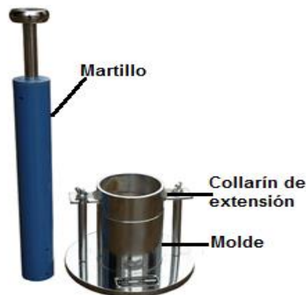
Figura 2.9. Molde, martillo y collarín de extensión, para ensayo de compactación tipo Proctor Estándar.
