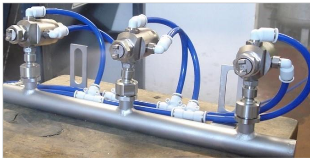
Ilustración 41.- Sistema Neumáticos de Pintura
