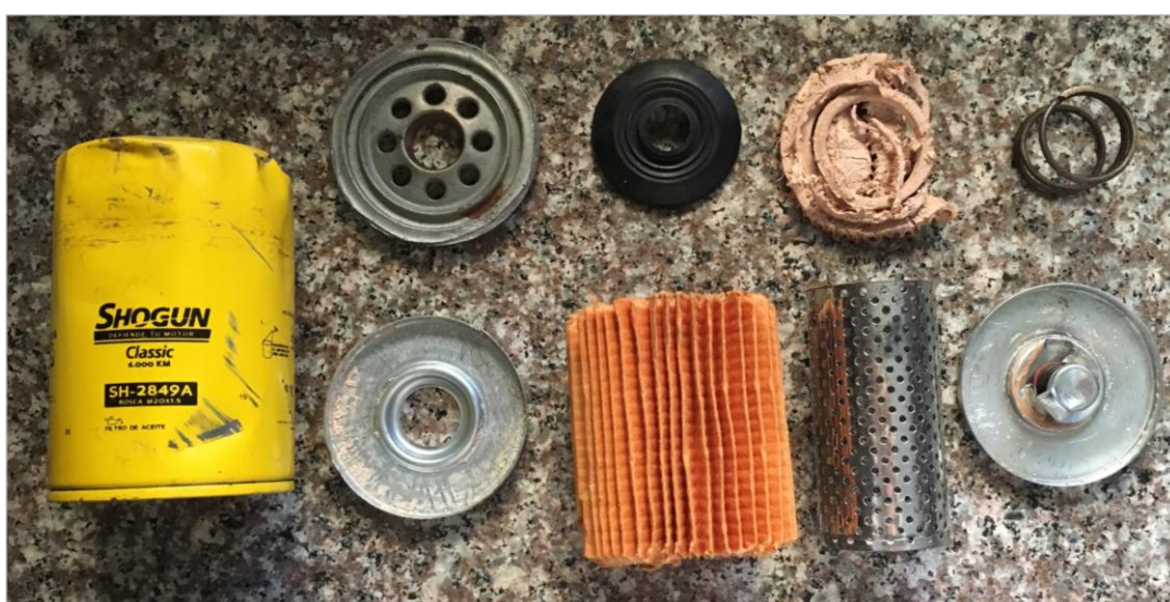
Ilustración 34.- Componentes de un filtro de aceite
