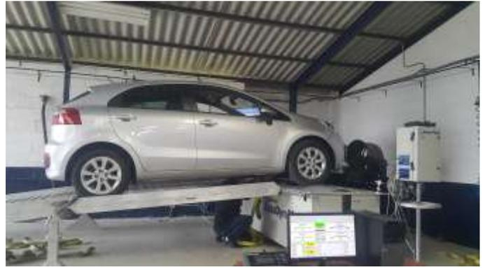
Figura 6. Pruebas en dinamómetro de chasis.
