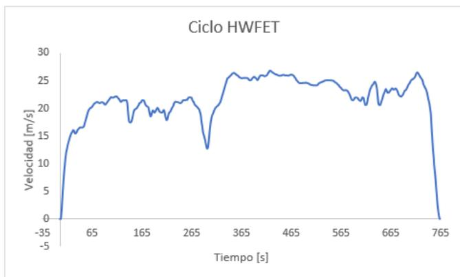
Figura 2. Ciclo de conducción HWFET
