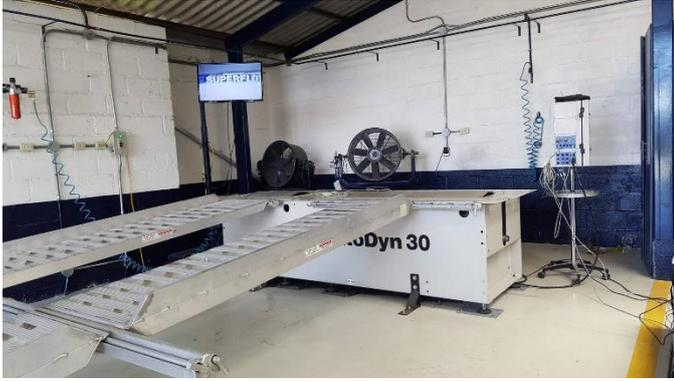
Fig. 2. Dinamómetro de chasis.
