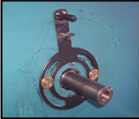
La **figura 92**, muestra el mecanismo para la selección de grados; éste sirve para la comprobación exacta del comienzo de inyección en cada uno de los elementos de la bomba de inyección de acuerdo al número de elementos. Este mecanismo trabaja conjuntamente con el tambor del cabezal graduado en 360°.
