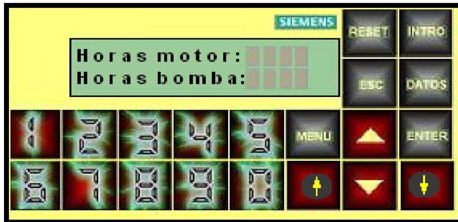
Estas son las pantallas que se pueden visualizar durante la operación del banco de pruebas y que permiten ejecutar el programa de control instalado en el PLC, activando y desactivando cada uno de los elementos que lo constituyen a través del teclado TD-200C gracias a su mutua intercomunicación.
