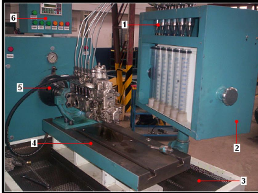
1.Conos porta - inyectores 2.Caja porta - probetas 3.Malla de protección
