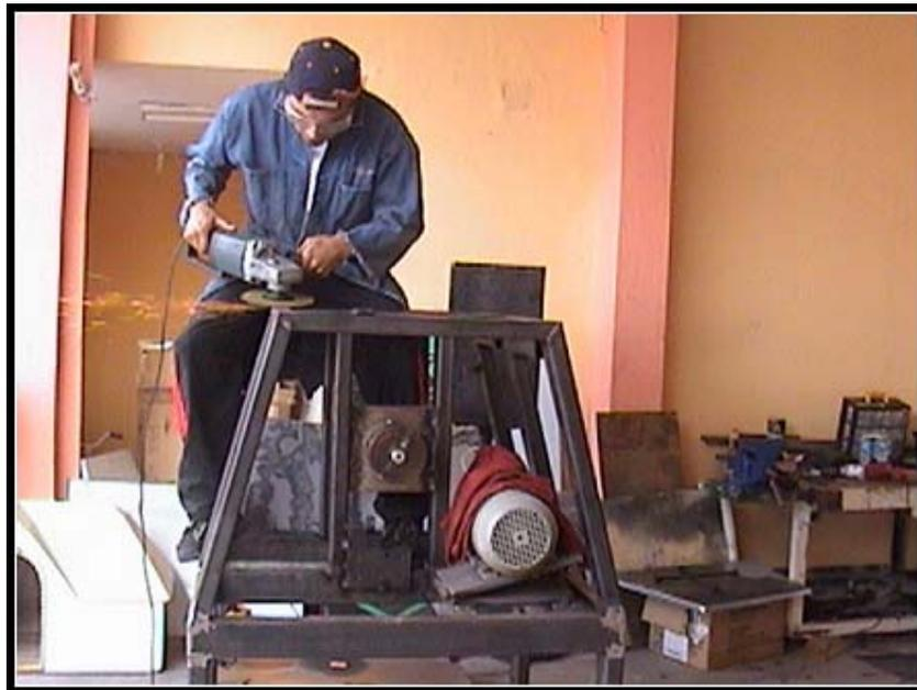
**Foto 14. Amolado de la parte superior de la estructura**
