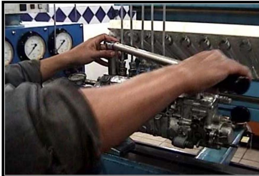
Ahora se continúa con la calibración del recorrido de los demás elementos de bombeo, verificando que su comienzo y final de la inyección se de con un desfase de 60° de acuerdo al orden de encendido.
