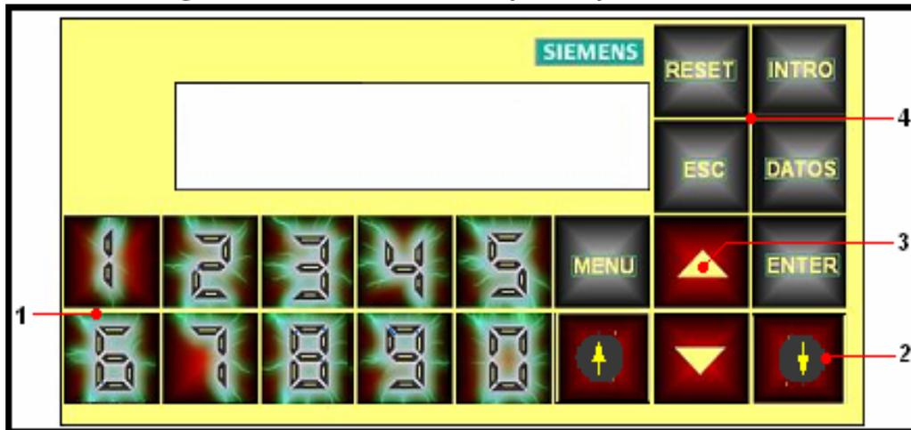
1. Bloque de teclas numérico      2. Teclas de activación directa del sistema de corte de combustible
