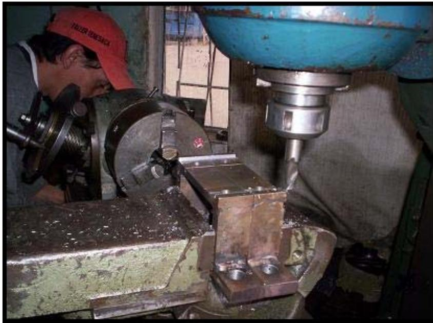
**Foto 10. Construcción de las placas de apoyo**
