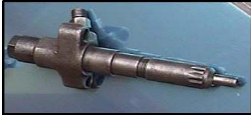
Los inyectores (1), van ubicados en la parte superior de la caja porta-probetas (4) (**Fig.151**), el líquido inyectado durante el funcionamiento del banco, es recolectado por unos conos plásticos (porta-inyectores) (2), que evitan la dispersión del diesel durante la inyección; posteriormente el líquido inyectado cae al interior de las probetas (3), en donde es medido para evaluar el estado de la bomba de inyección que se esté comprobando.
