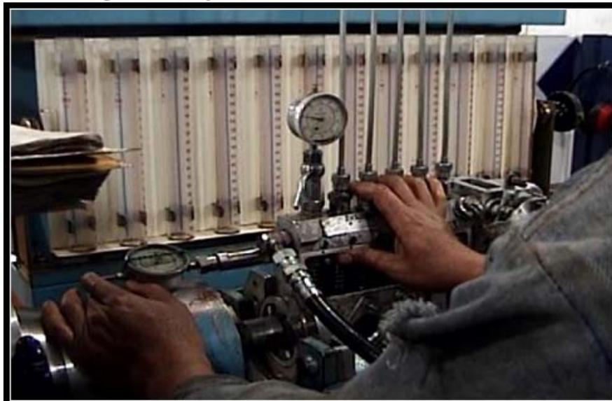
La presión de alimentación va a caer a 0 bar, debido a que el líquido comienza a salir por el tubo cuello de cisne. Para medir el recorrido útil del elemento de bombeo, este debe estar en su PMI; en esta posición se acerca el comparador ubicado en la parte superior del mismo y se mueve manualmente el cabezal del banco hasta que se produzca el corte o goteo del chorro que sale por el tubo cuello de cisne, en este instante se verifica la medida que señala la aguja del comparador (**Fig.211**).
