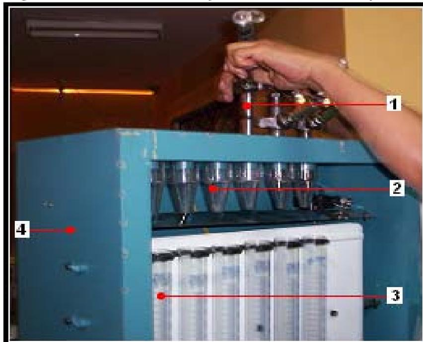
1.Inyectores 2.Porta-inyectores 3.Probetas 4.Caja porta-probetas
