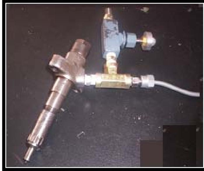
Como los inyectores montados en el banco de pruebas corresponden a los de un motor Nissan FD6, el tratamiento para su mantenimiento es similar al los de los vehículos. Es decir, se emplea un comprobador (**Fig.253**) en el que se sitúa el inyector en un acoplamiento apropiado, conectando al mismo una tubería de alta presión que le hace llegar el combustible desde una bomba manual.
