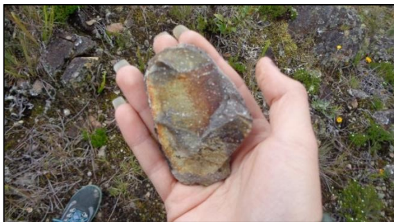
Figura 3.3. Dacita con fenocristales félsicos visibles a simple vista.
