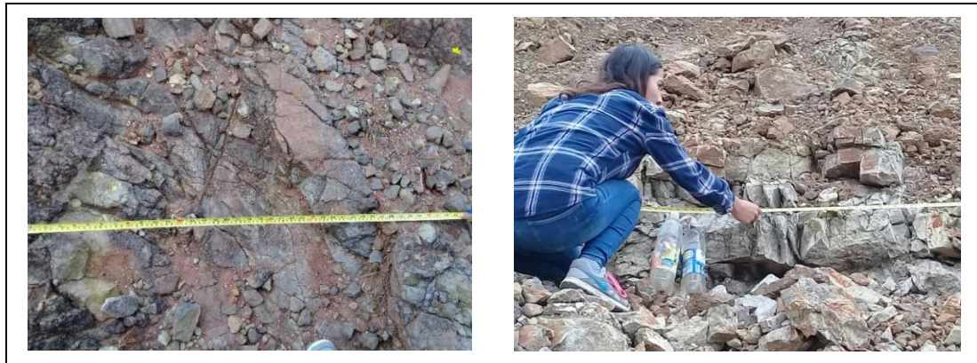
Figura 4.6. Medición de discontinuidades en frentes libres.
