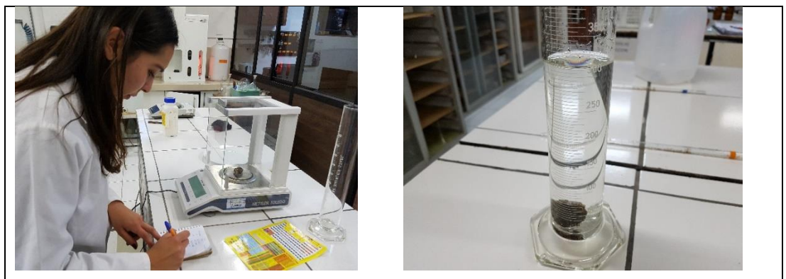
Figura 4.2. Pesaje de muestras y medición de volumen desalojado en probeta
