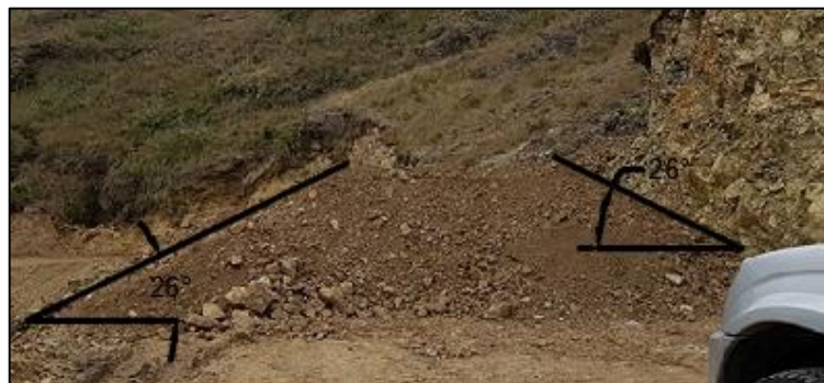
Figura 4.4. Ángulo de reposo natural del material
