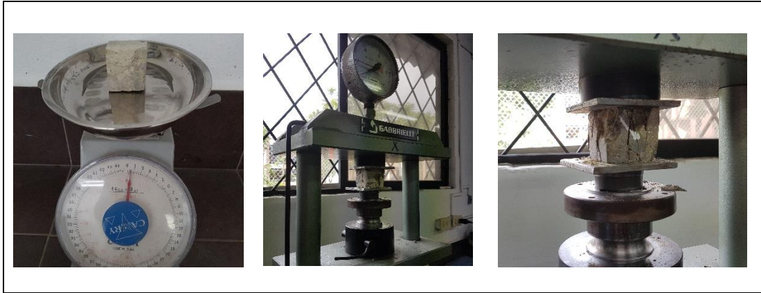
Figura 4.5. Pesaje de muestras y ensayo de resistencia a la compresión uniaxial.
