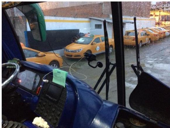
Figura 3.1 Colocación del GPS en la parte central del bus
