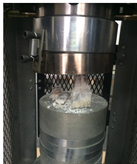
Figura 3.3: Ruptura de la muestra luego de haber realizado el ensayo de la compresión simple
