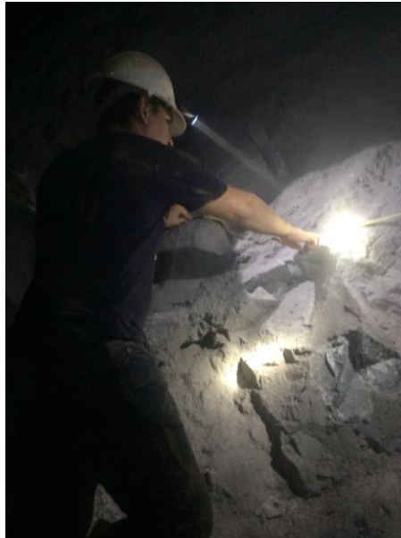
Figura 3.1: Medición de las fracturas en un metro lineal para lograr determinar el RQD de la roca circundante del túnel
