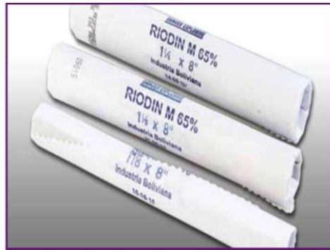
Figura 1.18: Explosivo Riodin M en forma de taco Fuente: (Maxam, 2008)
