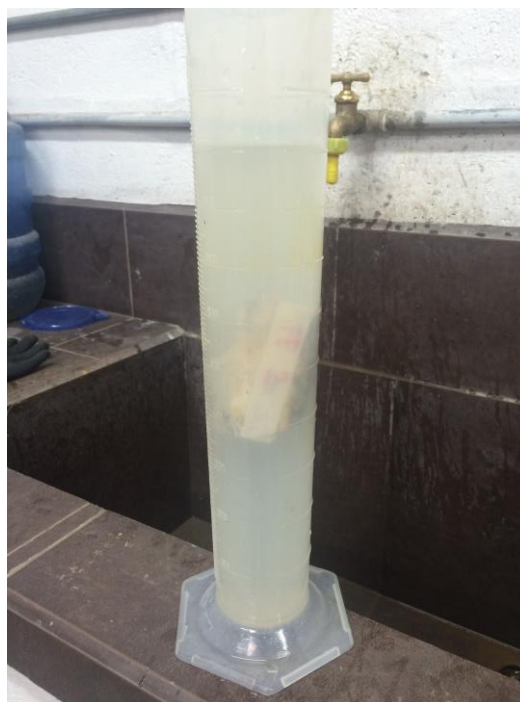
Figura 3.8: Colocación de las muestras dentro de la probeta para determinar su volumen
