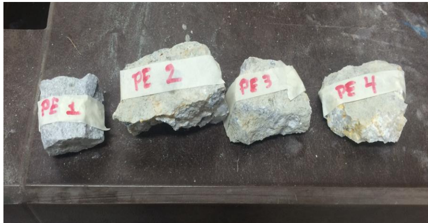
Figura 3.5: Cuatro muestras extraídas de la mina, previamente secadas para luego determinar su peso específico
