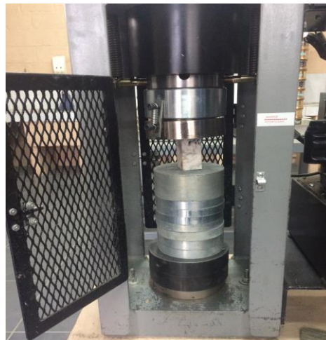
Figura 3.2: Colocación de la muestra para realizar la prueba de la compresión simple
