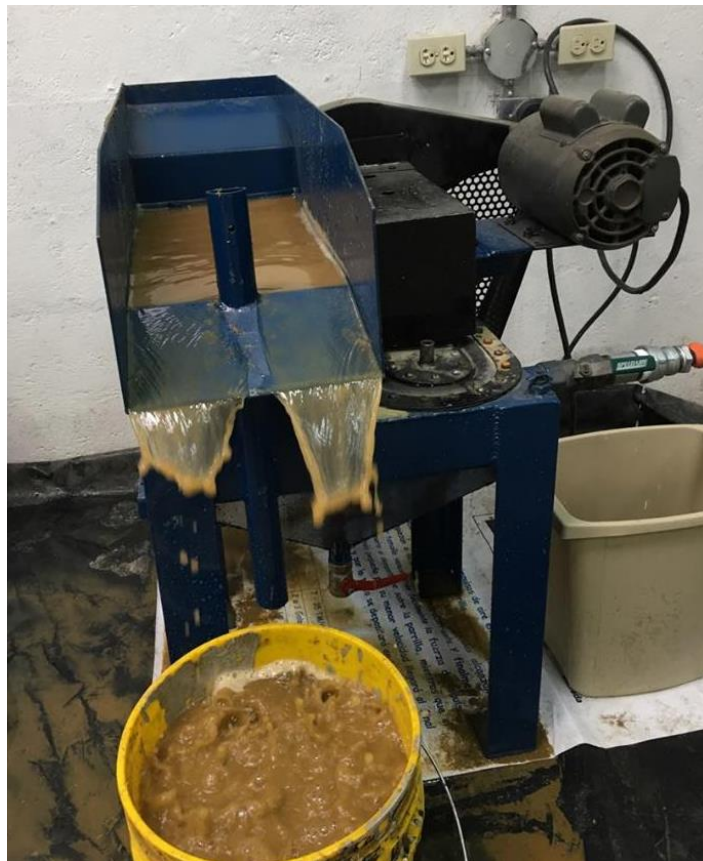
Figura 3.8. Proceso de concentración en el JIG.
