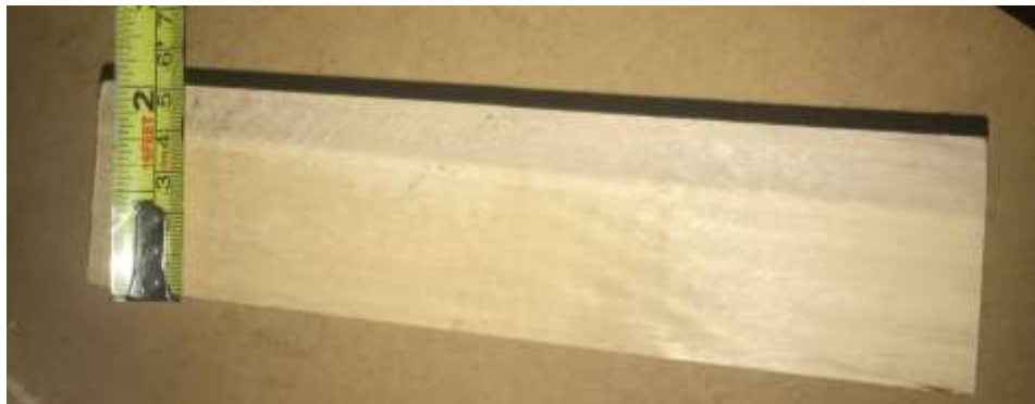
Figura 2.12 Dimensión lateral de la probeta de madera para compresión.
