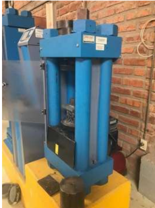
Figura 2.6 Máquina de compresión Matest S.p.A. Treviolo, utilizada para realizar las pruebas de compresión de la madera.
