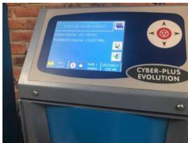
Figura 2.7 Panel de la máquina de compresión Matest S.p.A. Treviolo.
