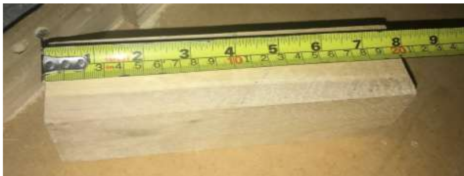
Figura 2.13 Dimensión longitudinal de la probeta de madera para compresión.
