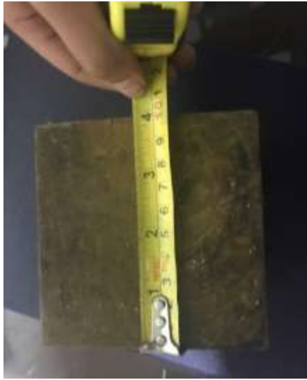
Figura 2.14 Dimensión lateral de la probeta de madera para microscopio.
