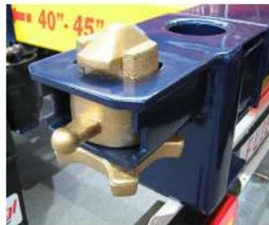
Figura 4.6. Funcionamiento Twist Lock Móvil
