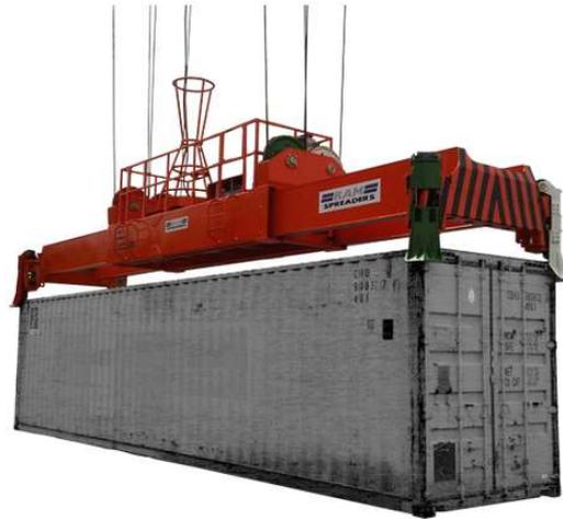
Figura 5.5. Funcionamiento de Spreader
