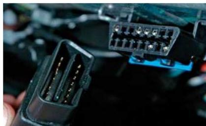
**Figura 2.1.** Conexión HEMdata en el conector OBD del vehículo
