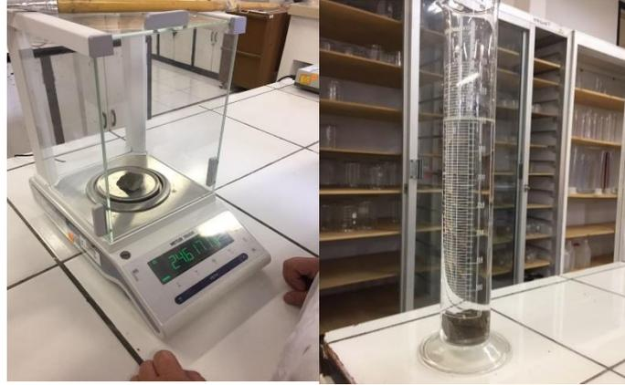
Figura 3.1. Peso y volumen de una muestra de roca.
