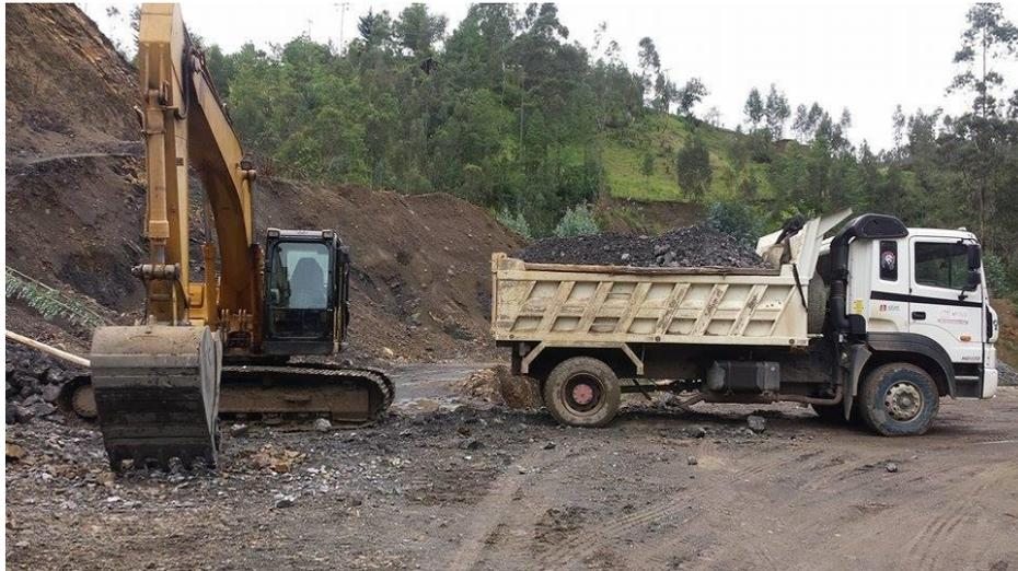
Figura 2.2. Carga y transporte Cat 320 CL y Volqueta Hyundai.
