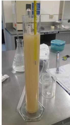
**Fig. 2.12** Lectura de densidad del aguamiel con higrómetro
