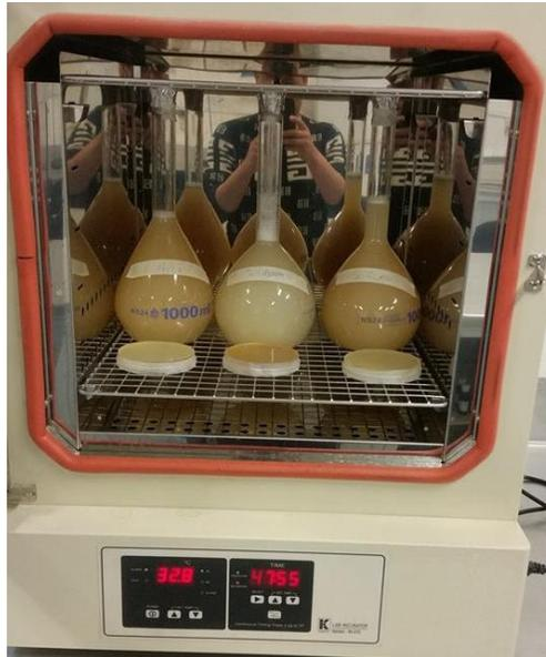
**Fig. 2.10** Incubación de agua miel con inulinasa
