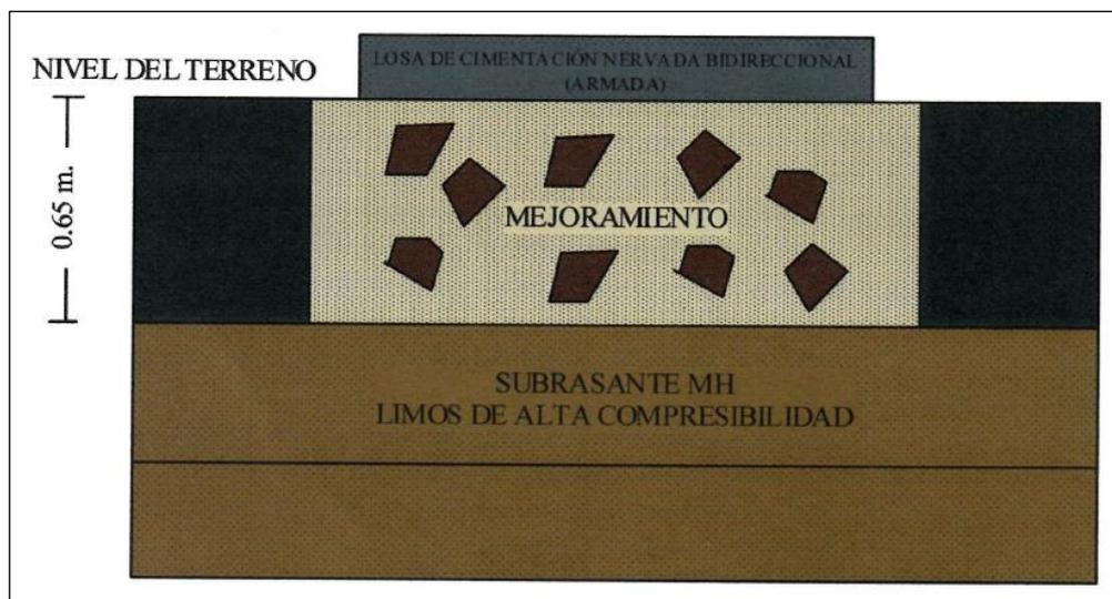
Figura 2. 14. Esquema de cimentación.
