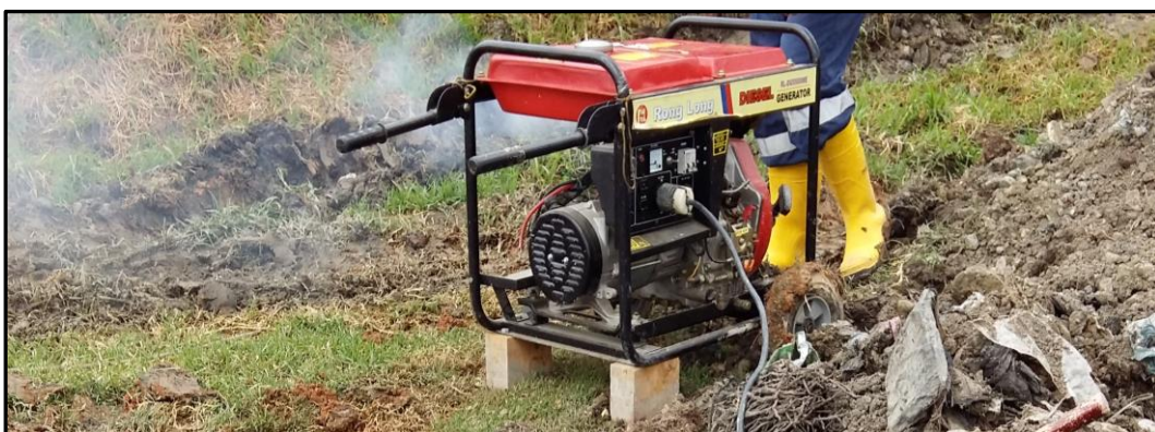
Figura 0.17. Generador a diésel utilizado para la maquina soldadora.
