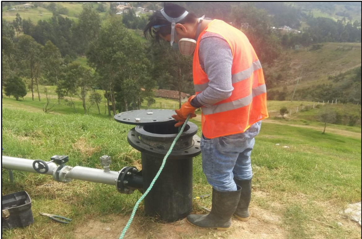
Figura 0.25. Mediante una cuerda determinamos la altura inicial del lixiviado.
