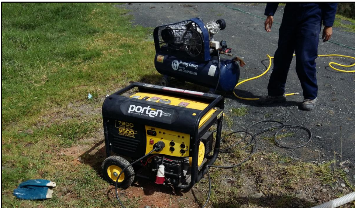
Figura 0.20. Generador y compresor utilizados en la extracción del lixiviado.
