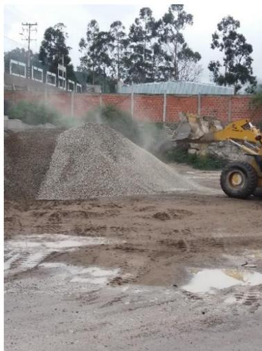
*Figura 7: Presencia de material particulado en hall de áridos Hormigones Guapán.*
