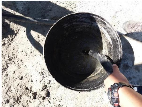
Figura 19: Aplicación de método volumétrico.
