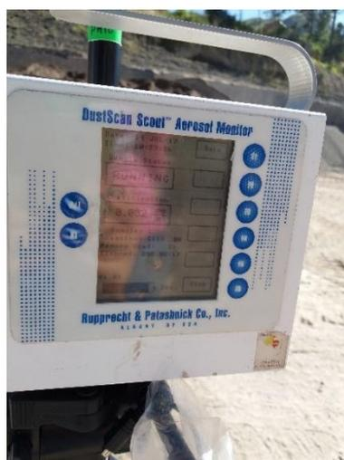
Figura 16: Equipo de monitoreo de material particulado.
