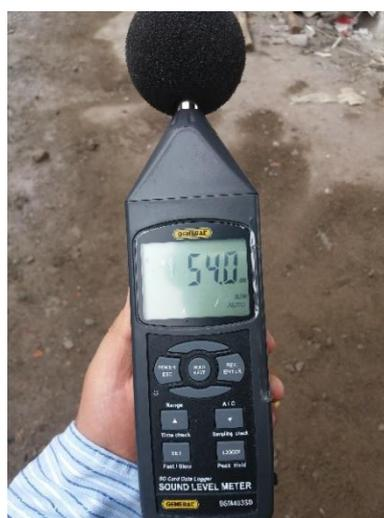
Figura 5: Instrumento de medición de ruido sonómetro.
