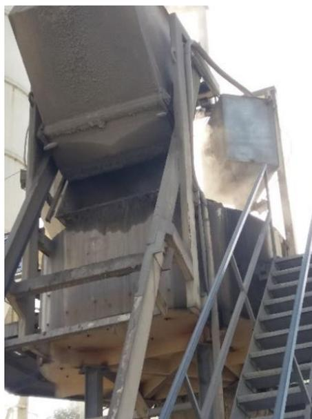
*Figura 9: Material particulado en mezcladora Hormicenter.*
