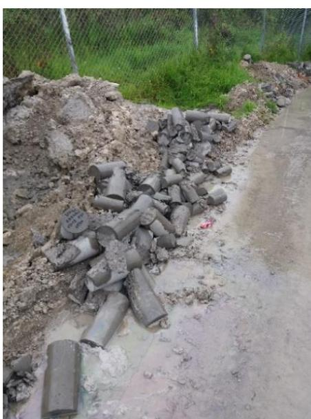
Figura 22: Residuos provenientes del ensayo de rotura.
