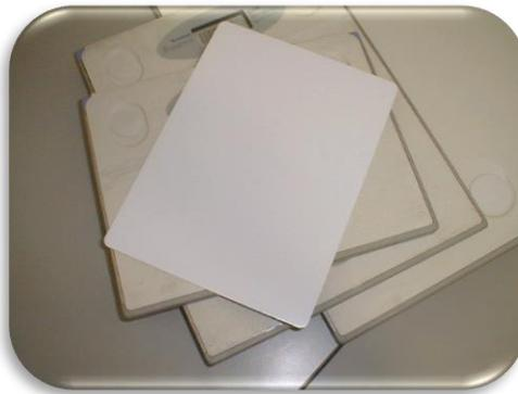
Figura 16:Láminas de fósforo IP
