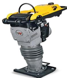
**Figura N° 2.9:** *Compactador común*
