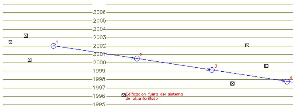
Figura 2.1. Tres edificaciones se pueden conectar a los tramos 1-2 y 3-4, la única edificación fuera del sistema de alcantarillado.
