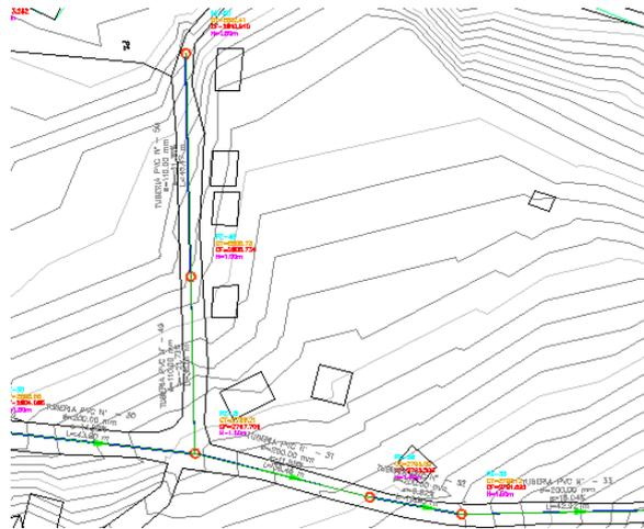
Figura 2.4. Red condominial dirección norte-sur se conecta al pozo de la red principal dirección oeste-este.
