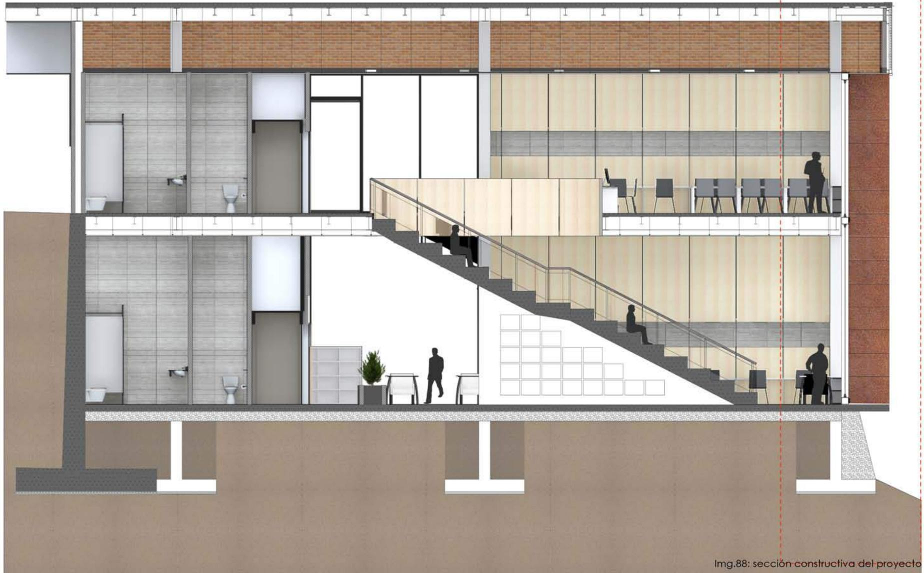
Img.88: sección constructiva del proyecto
