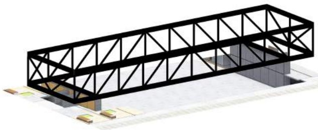
Descanso longitudinal de cercha sobre diafragmas
