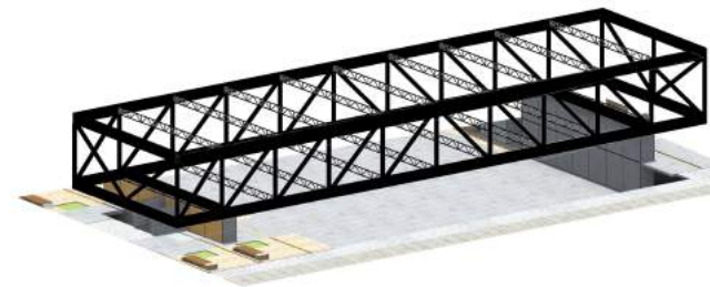
Colocación de cerchas secundarias
