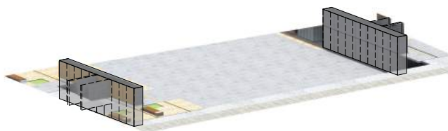
Colocación de diafragmas de hormigón
