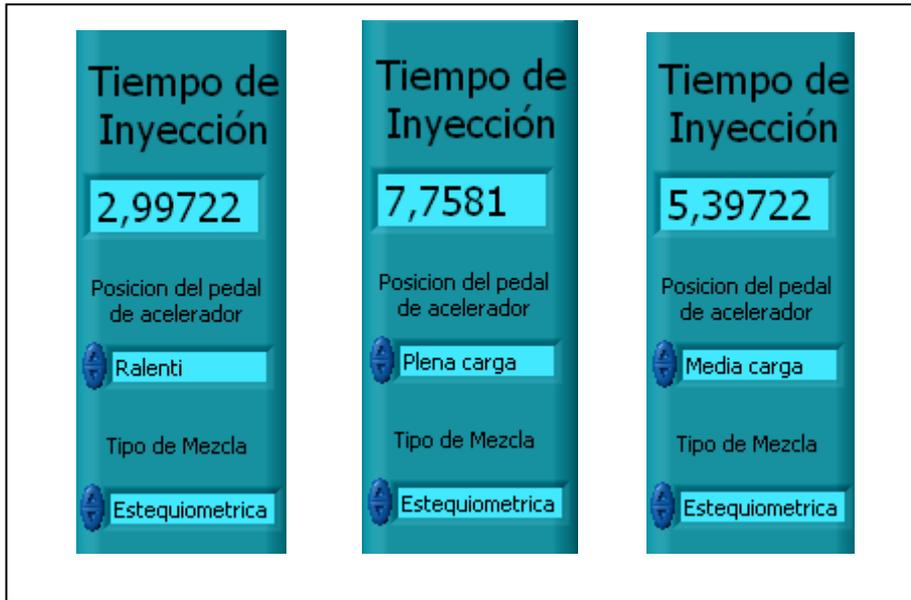
Fig. 3.26 Valores obtenidos para el Tiempo de Inyección (Sensor MAP). (LabVIEW®)
