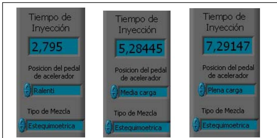
Fig. 3.27 Valores obtenidos para el Tiempo de Inyección (Sensor MAF). (LabVIEW®)
