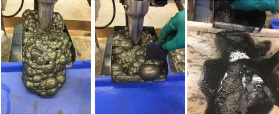
Figura 2. 10: Concentrados y Colas de Flotación
