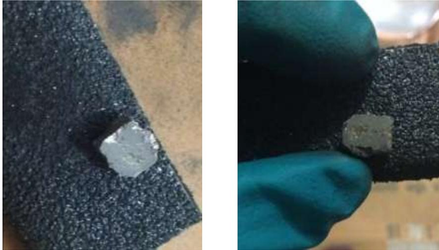
Figura 2. 2: Pulido de Muestra # 2 – Calcopirita.
