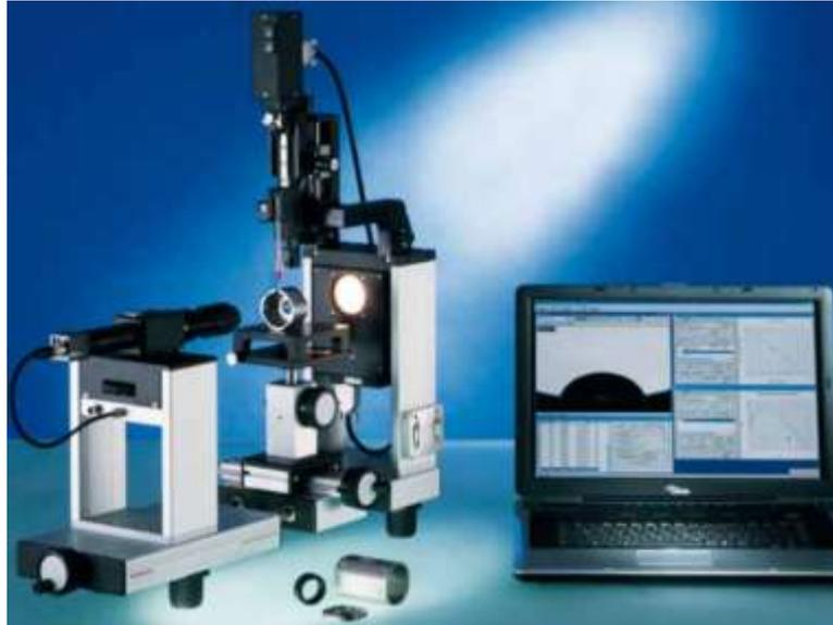
Figura 1. 31: sistema de medición de ángulo de contacto y análisis de contorno Oca 15 plus
