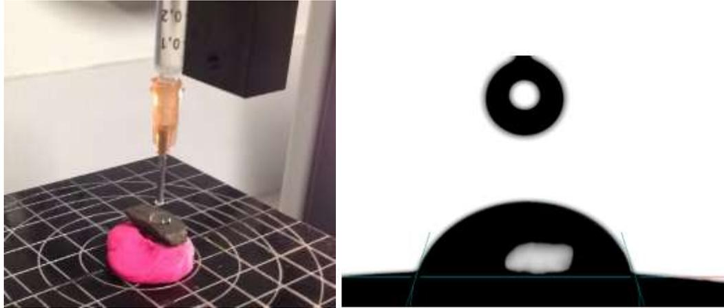
Figura 2. 4: Gota de reactivo sobre la superficie mineral
