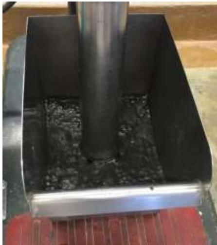
Figura 2. 5: Celda de Flotación de 1 litro – Porcentaje de Sólido (30%) y Líquido (70%) en suspensión.
