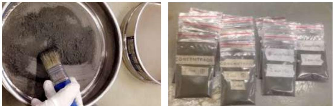
Figura 2. 9: 10 g de muestra de los concentrados y colas de una flotación.
