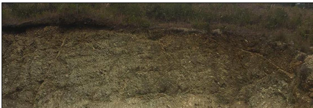
Figura 2.19: Persistencia de discontinuidades en corte del terreno. Fuente: Autor.
