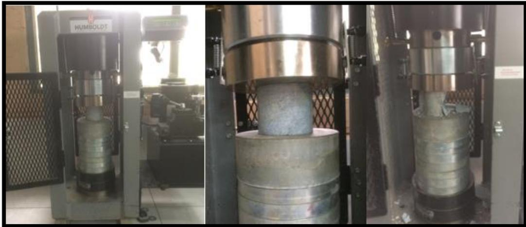
Figura 3.13 P. Resistencia Compresión Simple
