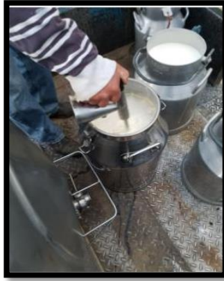
Ilustración 8: Transportista realizando prueba de acidez con pistola de alcohol
