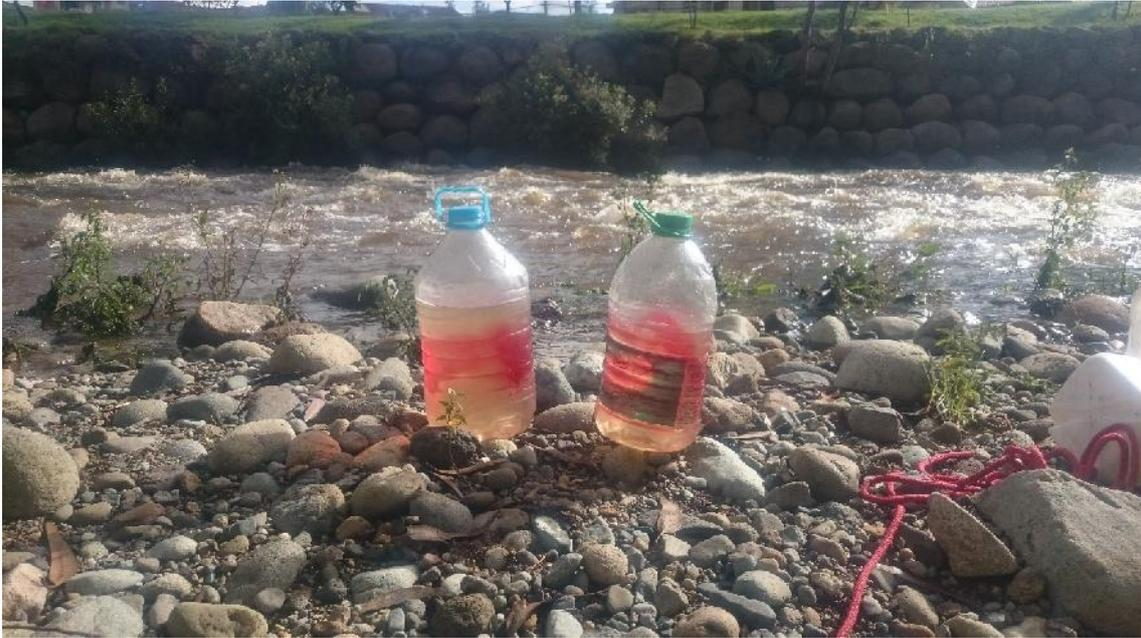
Figura 15: Flotador con botellas plásticas.
