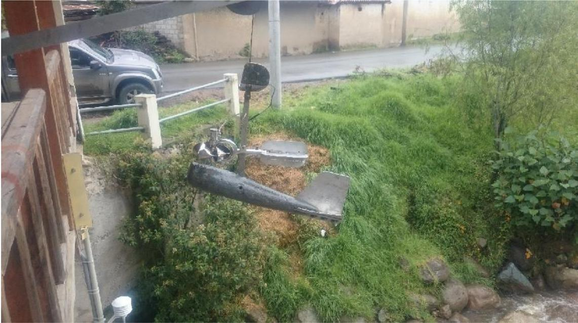
Figura 23: Aforo con molinete en el sector del puente de Barabón.
