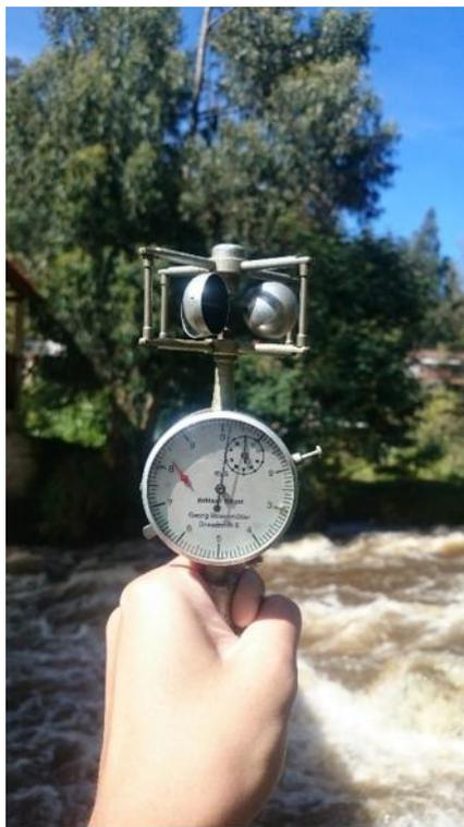
Figura 2.8. Anemómetro de mano usado durante los aforos con flotador.
