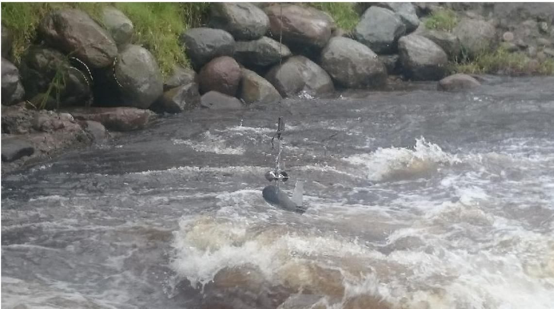
Figura 24: Aforo con molinete en el sector del puente de Misicata.
