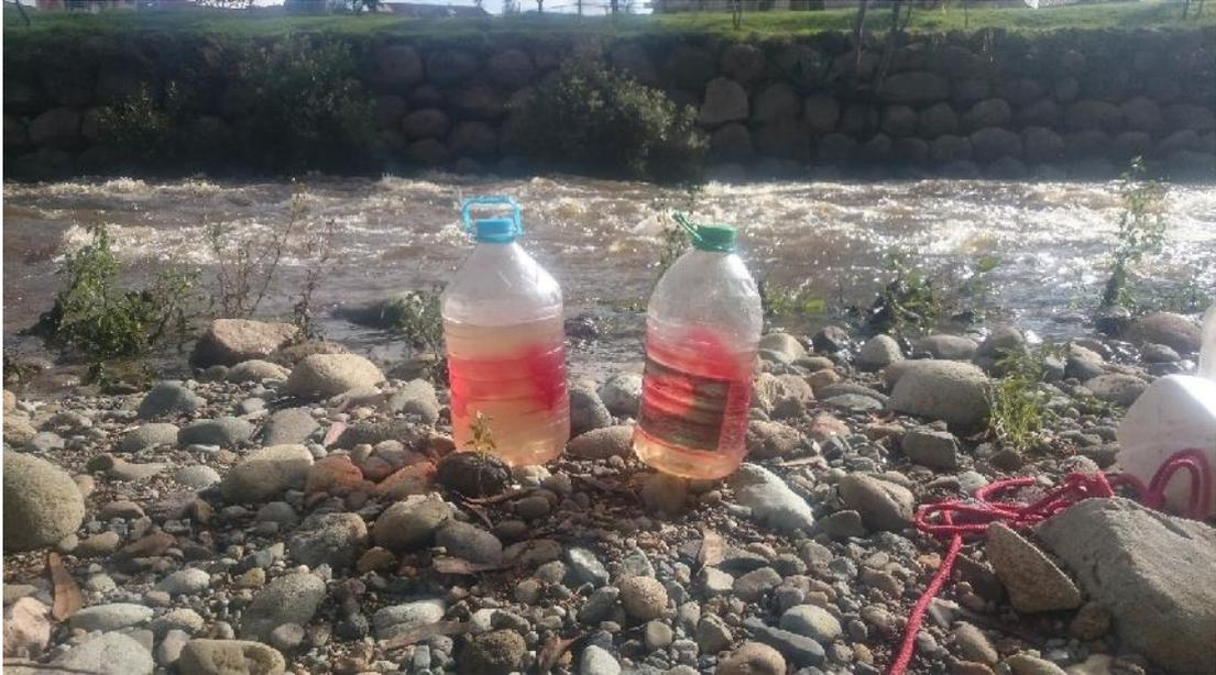
Figura 2.5. Flotar de botella plástica usado durante pruebas de flotación.
