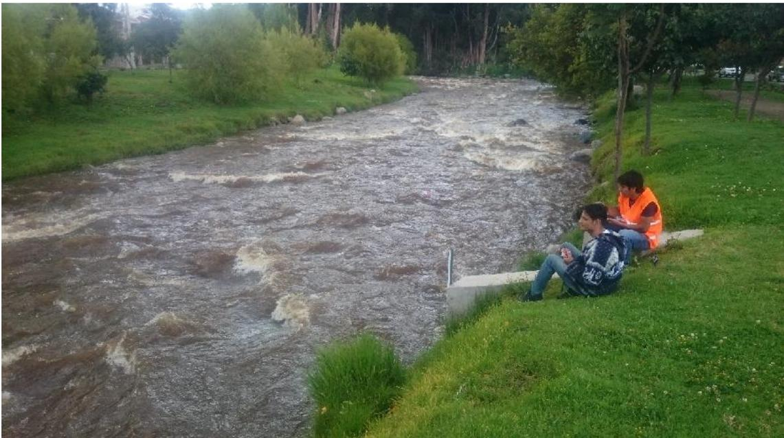
Figura 22: Aforo con flotadores en el sector de la Av. Felipe II.
