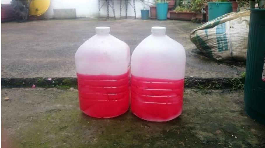
Figura 2.6. Flotador de botellón plástico usado para pruebas de flotación.
