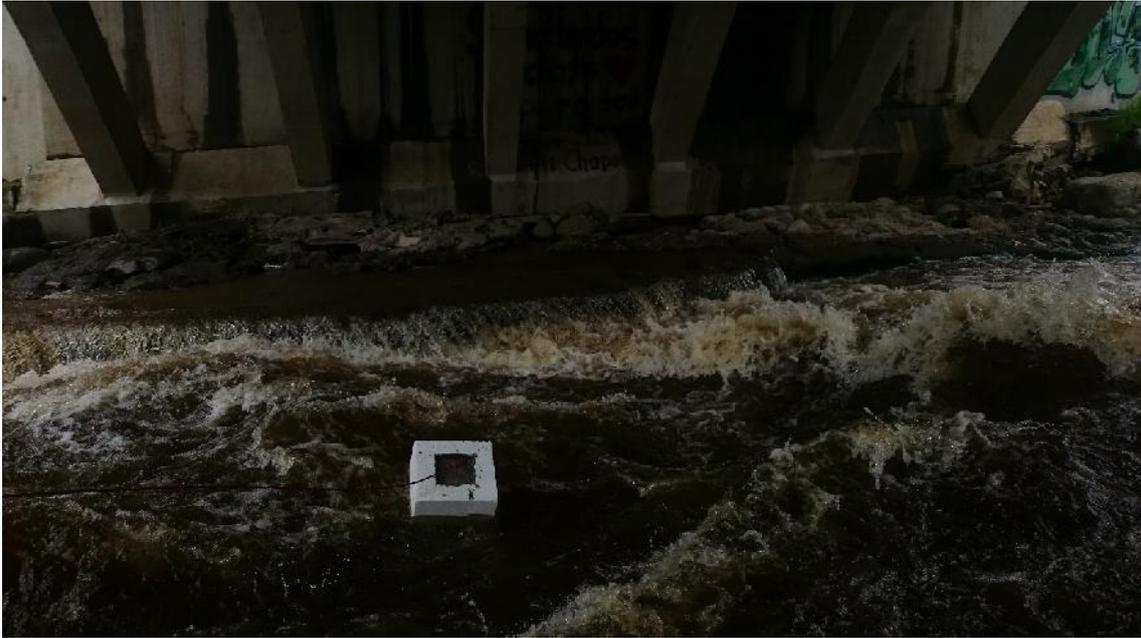
Figura 17: Prueba de flotadores con poliestireno expandido en el puente Misicata.
