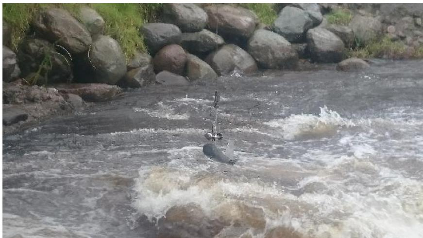
Figura 2.10. Molinete de cazoleta usado para los aforos
