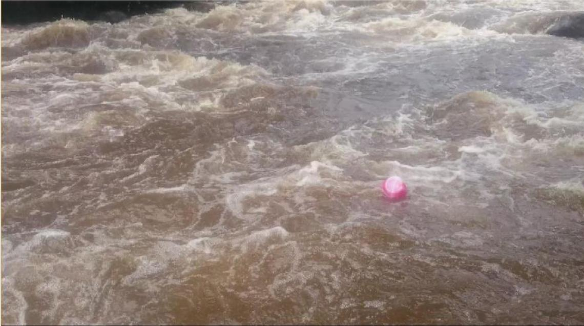
Figura 19: Prueba de flotadores con botellones de 1 galón, en el puente Barabón.
