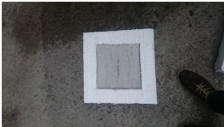
Figura 2.4. Flotador de poliestireno expandido y hormigón, elaborado para pruebas de flotación.
