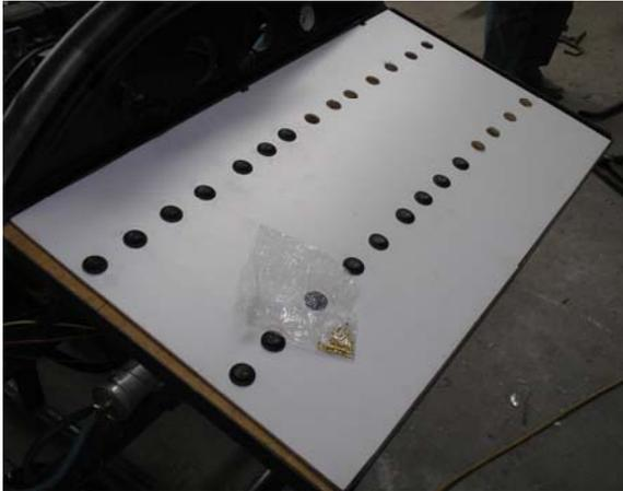
Armado del tablero de instrumentos externo
