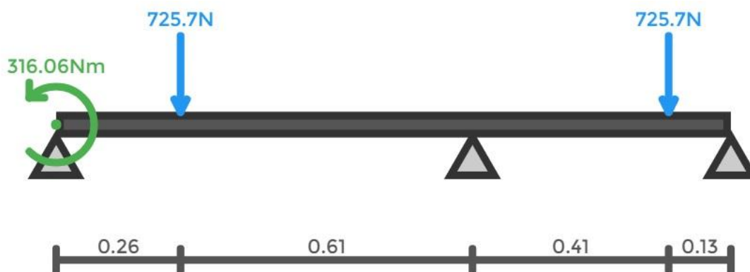
Fig. 8. Larguero del chasis de la tricimoto con las cargas y apoyos.
