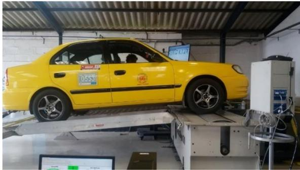
**Figura 2.16.** Primer Hyundai Accent 2005 montado en el dinamómetro.
