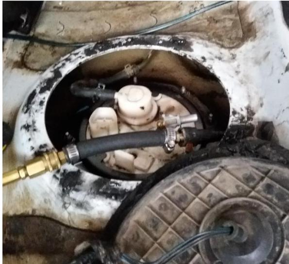
**Figura 2.104.** Conexión del cánister hacia el riel de combustible.
