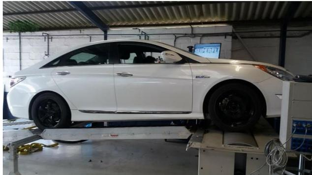
**Figura 2.15.** Sonata Híbrido montado en el dinamómetro de chasis.
