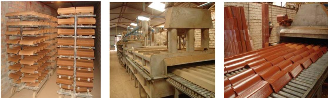
Para las tejas de colores, se hace un pigmento con cobre el cual se compra ya preparado. Se les da a las tejas un baño antes de ingresar al horno.
