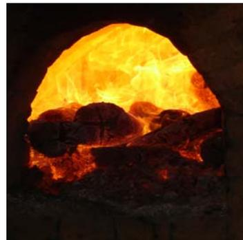
Los ladrillos de abajo se queman más pronto que los de arriba, salen más caldeados y tienen un color diferente como para ladrillo visto, muy utilizado en cerramientos. Estos son los mejores y más duros. De los 15500 que entran en el horno, unos 12000 se queman abajo.
