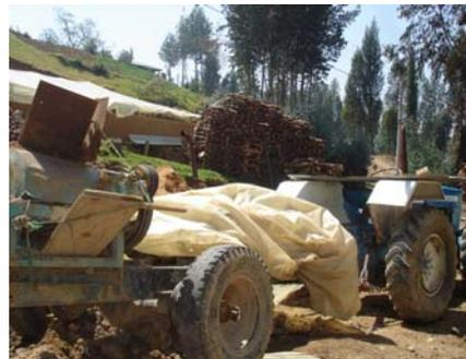
Para utilizar la máquina y hacer la mezcla, se tiene que prender el motor, se pone en cambio y este gira y muele la tierra que cae, se pone en la carretilla y es llevada y echada en el noque, un pozo, con agua para de ahí meter la yunta.
