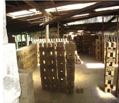
A los 8 días se raspan los ladrillos para que queden parejos y después de unas dos semanas se llevan al horno. En el horno del Sr. Malo entran 17000 ladrillos. La duración para la quema es de un día y una noche, 24 horas.
