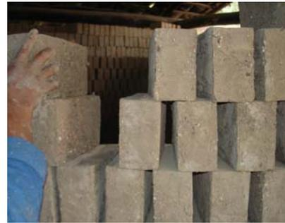
Alrededor de un mes se demoran en estar completamente secos y poder entrar al horno que es a base de ladrillo, con una capacidad de 8000 ladrillos.
