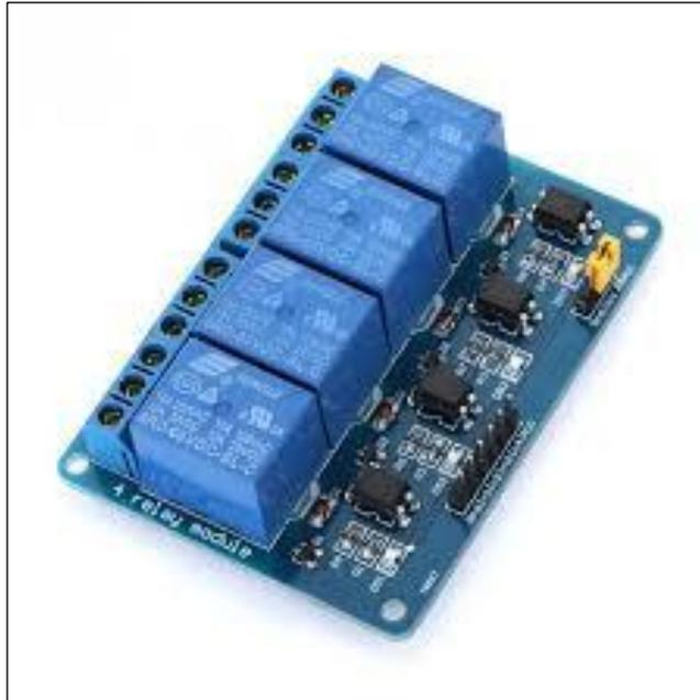
Figura 3.6: Modulo Relé de 4 canales
