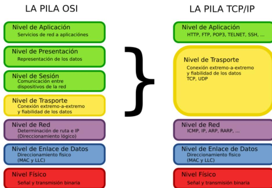
Figura 2.13: Comparación del Modelos OSI con TCP/IP
