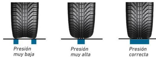
Figura 2.1. Esquema de la presión en neumáticos.
