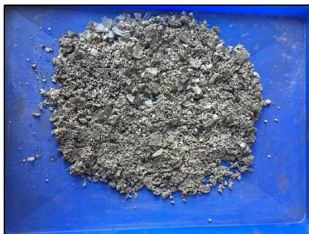
Figura 2.9. Trituración previa, tamaño de grano oscila entre 2-3 cm de diámetro
