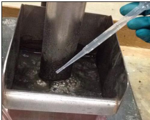
Figura 2.6. Espumación resultante del uso de MIBC
