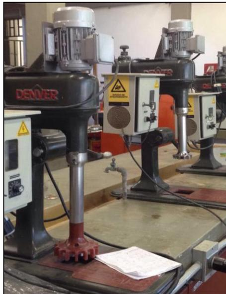
Figura 1.10. Celdas tipo Denver - Laboratorio CIMEX
