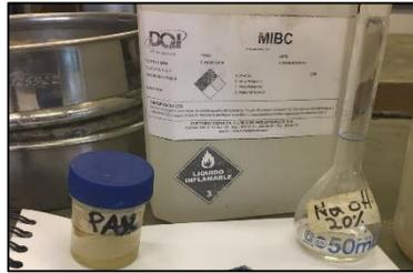
Figura 2.4. Reactivos químicos dispuestos para la flotación de oro.
