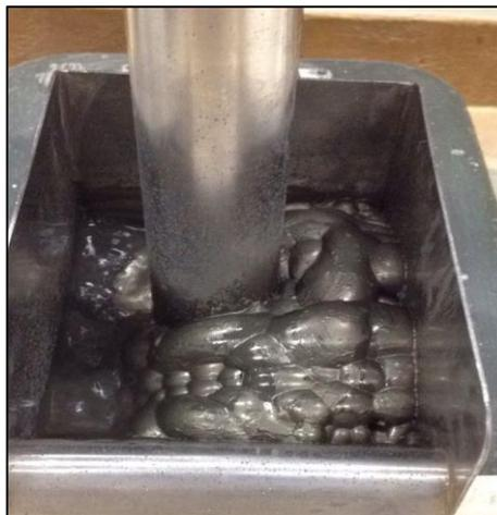
Figura 2.5. Espumación resultante del uso de AEROFROTH 65
