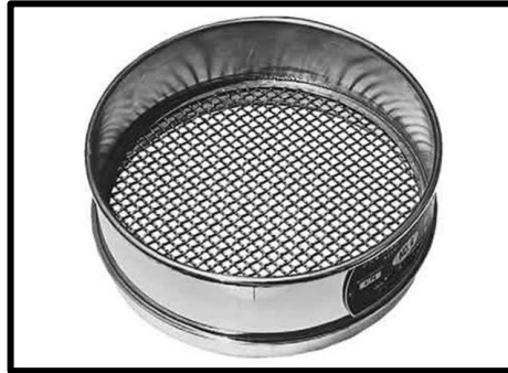
Figura 1.2 Tamiz para el análisis granulométrico Fuente: (Bustamante, 2007)
