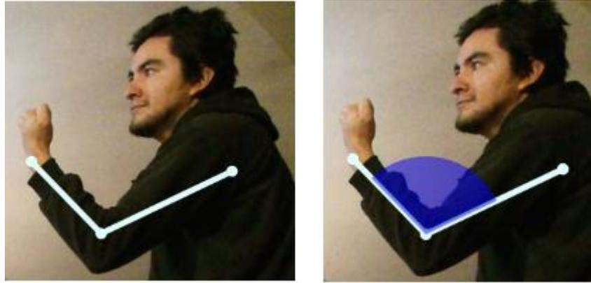
Ilustración 5: Izq.- (A) Detección de extremidades (rectas) y articulaciones (puntos). Der.- (B) Dibujo del ángulo entre articulaciones.
