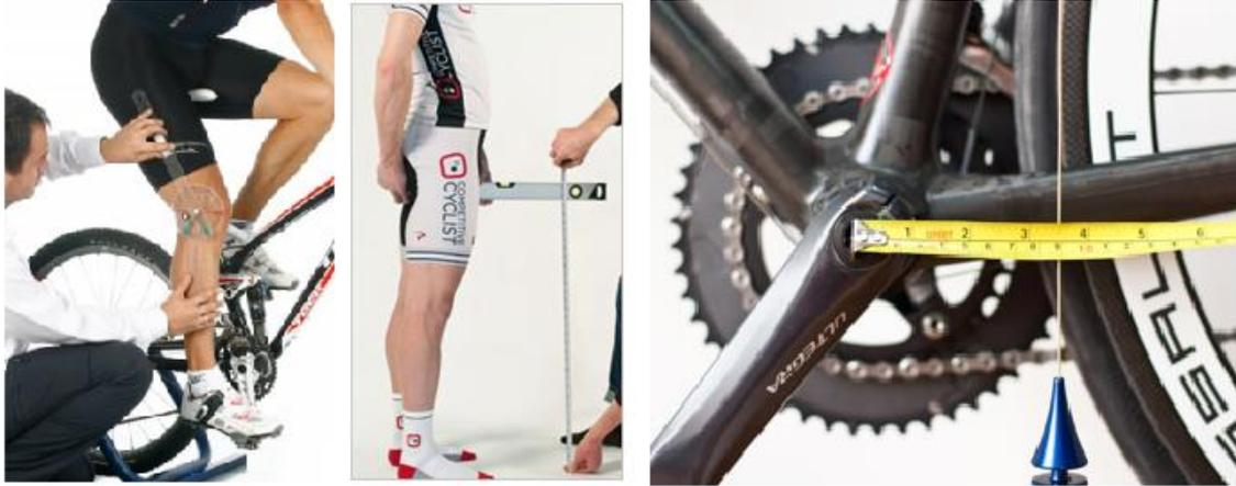
Ilustración 2: Herramientas para realizar bikefit. De izquierda a derecha: Graduador, rodillo estático, nivel, cinta para medir, plomada, flexómetro [13].
