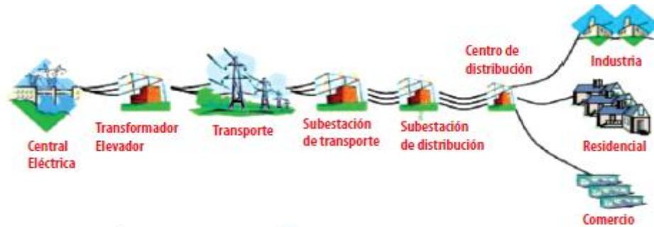
Figura 3.1: Estructura de la red eléctrica.
