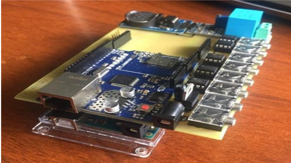
Figura 4.15: Tarjeta de expansión para Arduino.
