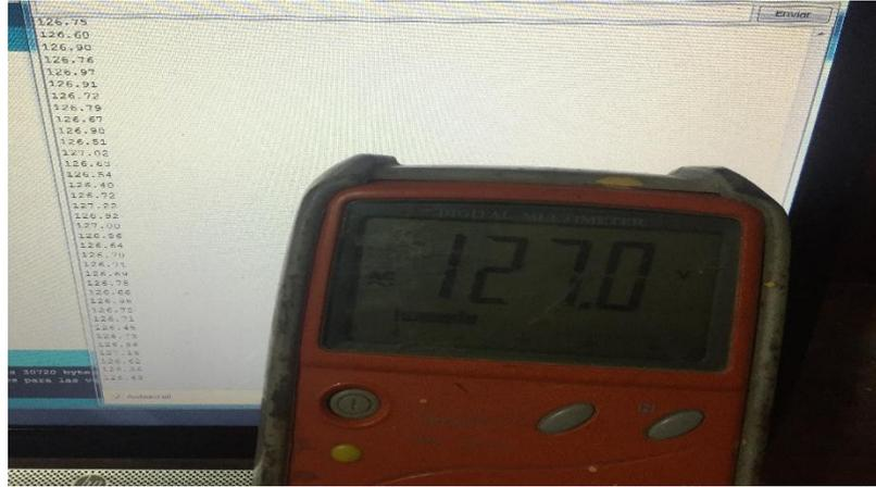
Figura 5.2: Calibración del sensor de voltaje.
