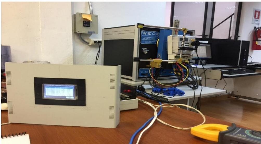
Figura 5.3: Instalación del equipo para la contrastación de medición en el laboratorio de medidores de la empresa CENTROSUR.
