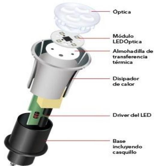
Figura 3.29: Partes de una lámpara led.
