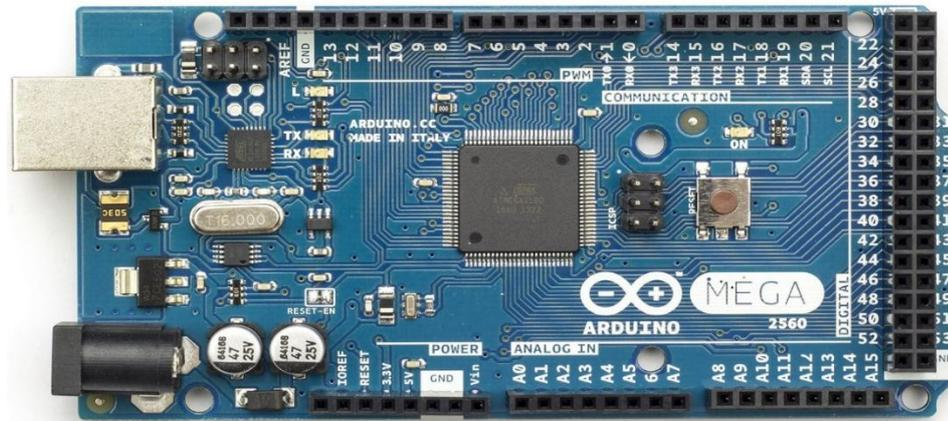
Figura 4.2: Arduino Mega 2560.
