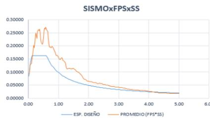
**Figura 23.11:** Sismos escalados para análisis dinámico lineal y no lineal
