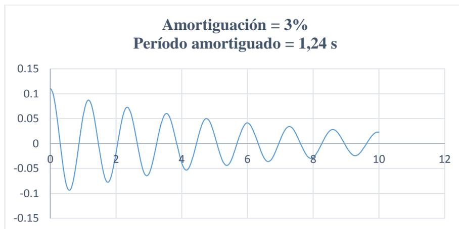
Figura 2.19: Vibración libre pórtico 4
