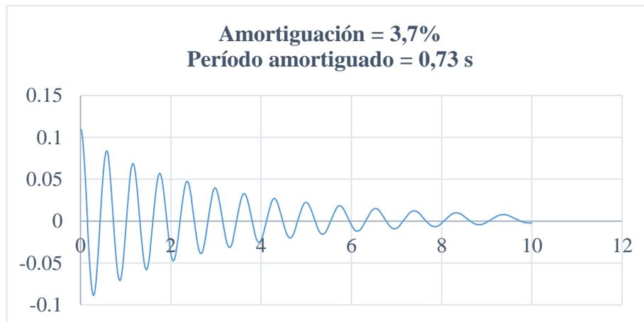
Figura 2.18: Vibración libre pórtico 3
