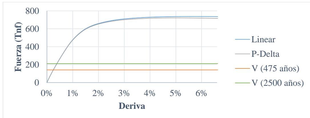
Figura 2.13: Curva Pushover con efecto Lineal y P – Delta del pórtico 2
