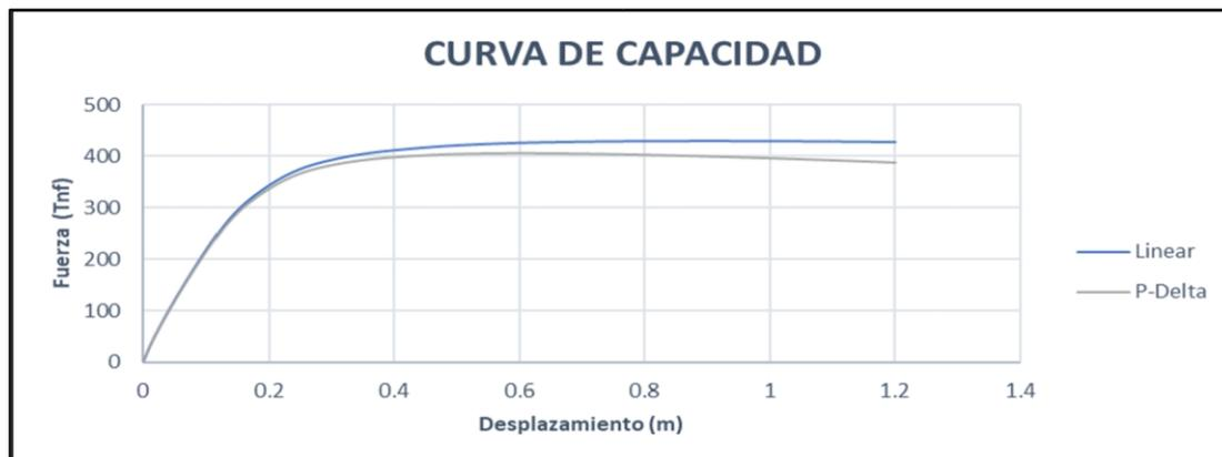
Figura 2-13 Curva de capacidad considerando efectos P-Delta y lineal.
