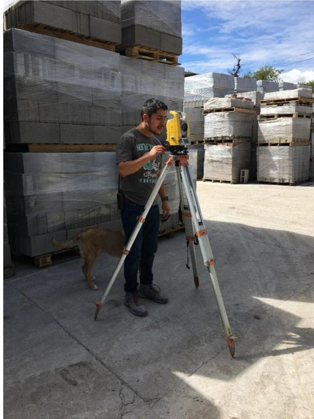
Después de obtener los puntos en que se ubica cada elemento en la planta, según la estación total, se los pasó a AutoCAD para dibujarlos y proceder con la elaboración del Layout, obteniendo el siguiente resultado (Ver plano en anexo 1).
