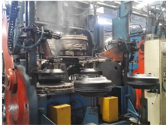
**Figura 3.1:** Prensa para vulcanizar neumáticos PLT.
