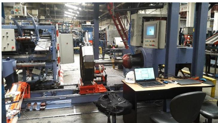
**Figura 1.10:** Maquina constructora para de llanta verde.
