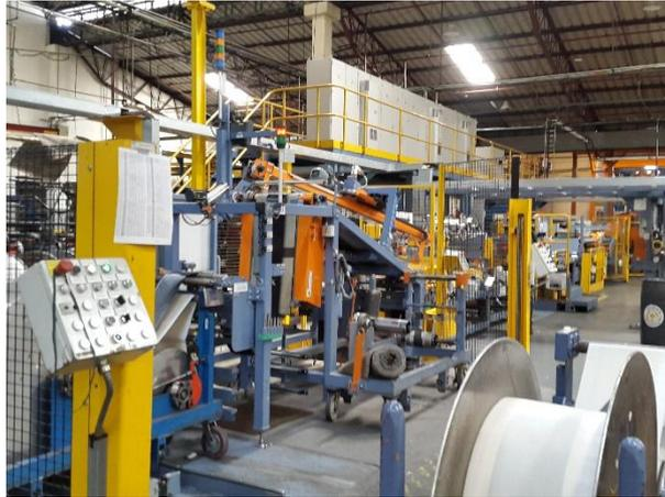
**Figura 1.9:** Maquina cortadora de breakers.
