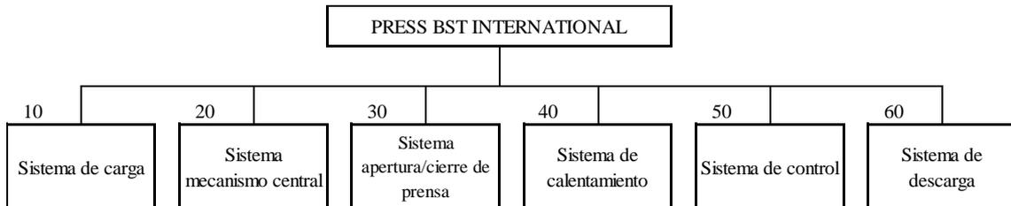
**Figura 4.42:** Diagrama general de subsistemas de una prensa PRESS BST INTERNATIONAL
