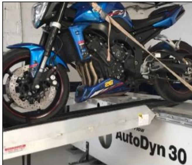
Figura 10: Banco Dinamométrico AutoDyn 30 Superflow
