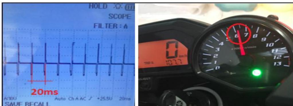
Figura 21: Variación del tiempo entre cada pulso (6300 Rpm)
