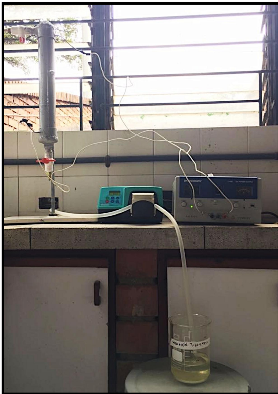
Figura 2.9. Montaje del laboratorio de Electro-lixiviación en columna
