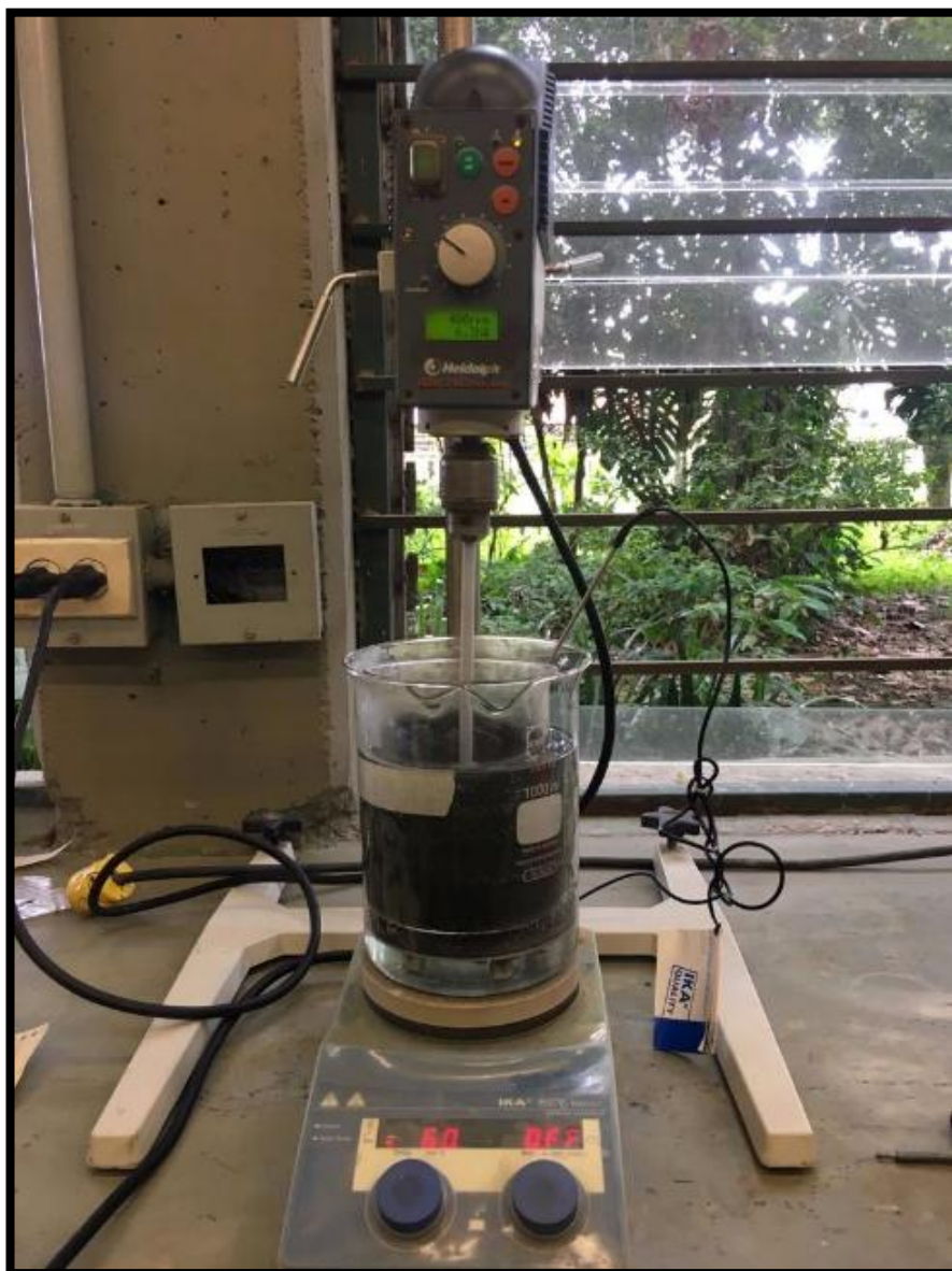
Figura 2. 13. Montaje del laboratorio de lixiviación por agitación
