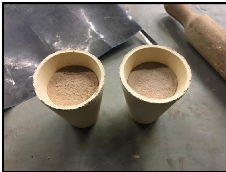
Figura 2. 15. Mezcla homogenizada entre la muestra mineral, los reactivos y fundentes
