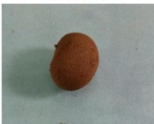
**Foto (11).** Comprobación de un secado idóneo del suelo, amasando la bola entre las palmas de las manos.
