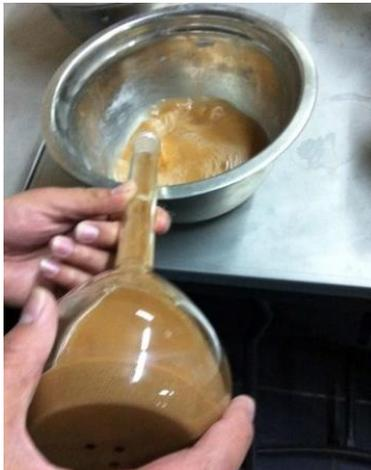
**Foto (14).** Determinación de la masa de los sólidos del suelo, una vez concluido el período de secado.
