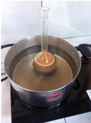
**Foto (8).** Agua destilada agregada sobre la marca de enrase.
