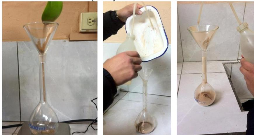
**Foto (5).** Llenado de 1/2 de la altura del cuerpo principal del matraz con agua.
