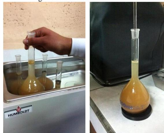
**Foto (11).** Secado del exceso de agua, y posterior determinación de la masa del matraz, del agua y del suelo.
