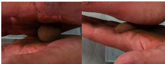
**Foto (12).** Rolado la bola entre las puntas de los dedos y la placa de vidrio, ejerciendo suficiente presión para formar un rollo de aproximadamente 3mm.
