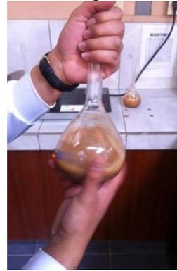
**Foto (7).** Extracción de aire mediante ebullición.
