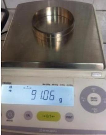
**Foto (2).** Masa del anillo y de la muestra húmeda.
