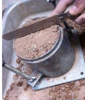
**Foto (5).** Masa de suelo compactado + placa base + molde.
