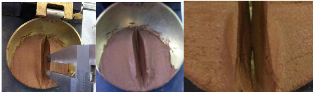
**Foto (8).** Porción de suelo tomada de la zona donde se juntan los bordes de la ranura, empleado para la obtención del contenido de agua.
