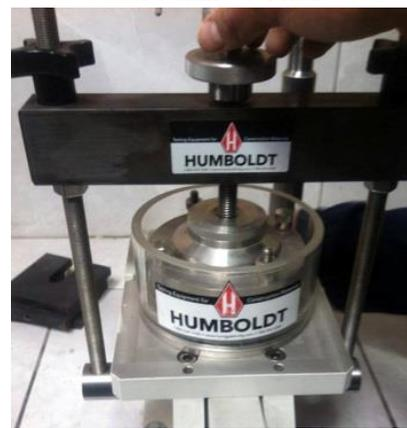
**Foto (5).** Palanca de carga nivelada horizontalmente.
