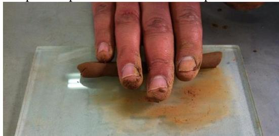
**Foto (13).** Moldeado del rollo formando una bola y posterior rolado hasta alcanzar el agrietamiento a los 3 mm de diámetro.
