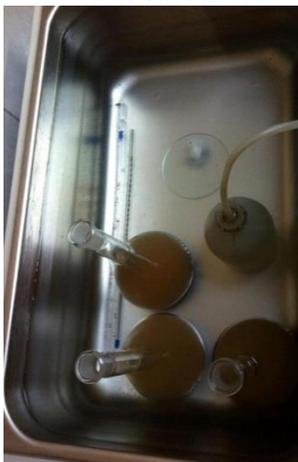
**Foto (10).** Matraz extraído del recipiente de baño maría y posterior ajuste del nivel de agua hasta la marca de enrase.
