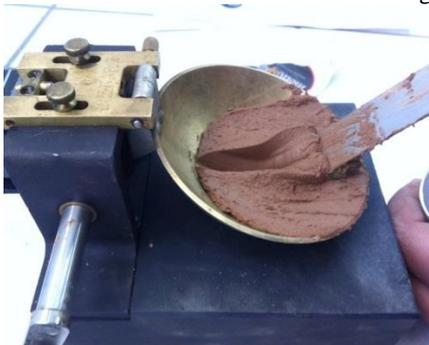
**Foto (9).** Incrementos de agua destilada, hasta obtener un mínimo de 4 puntos (2 sobre 25 golpes y 2 inferiores ha dicho valor).
