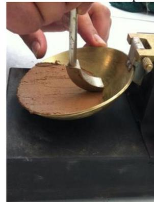
**Foto (7).** Fondo de la ranura se cierra a una distancia continua de 12.7 mm.
