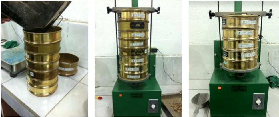
Foto (12), (13), (14) y (15). Determinación de la masa de suelo en cada tamiz.
