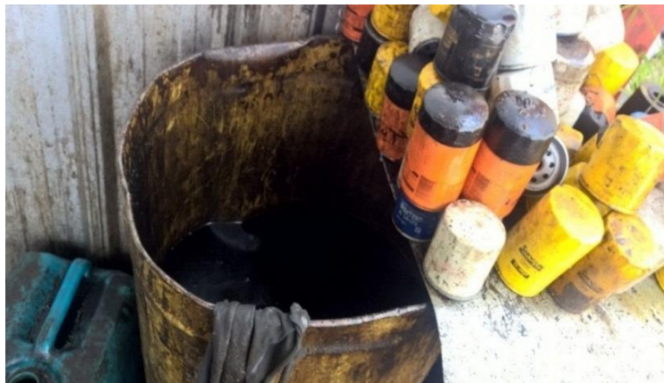
Figura 2.17: Incorrecto almacenamiento de aceite y filtros por parte de Talleres y repuestos Ramón.
