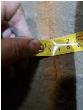
Figura 2.4: Medición del espaciamiento entre discontinuidades.
