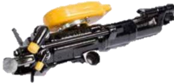
Figura 3.11: Máquina de barrenación YT-27.
