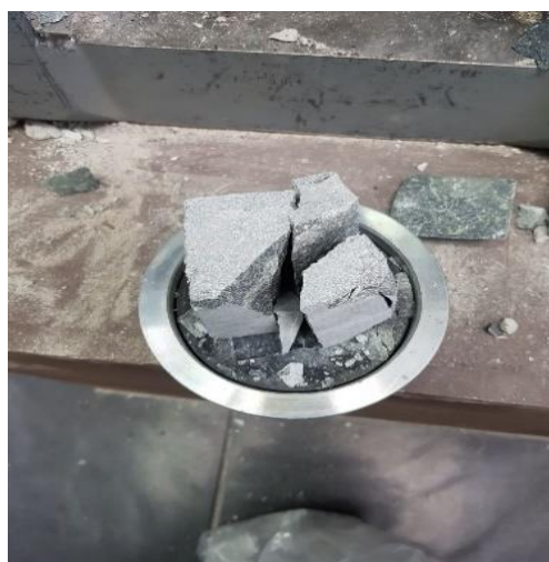
Figura 2.2: Prueba de compresión uniaxial.
