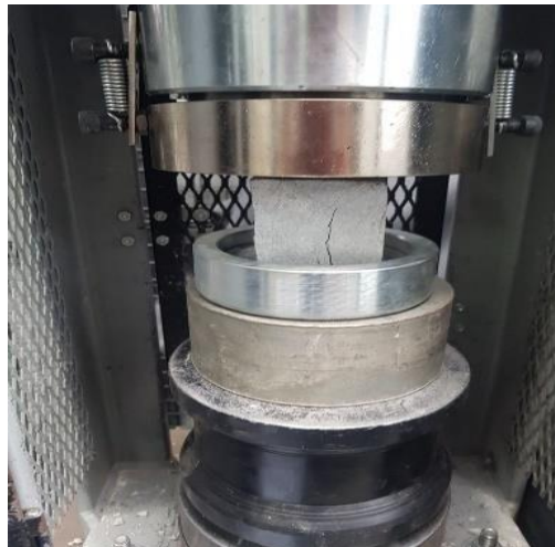
Figura 2.2: Prueba de compresión uniaxial.
