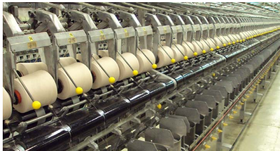
Figura 7. Sistema de retorcido del filamento PET (Mejía, 2011).
